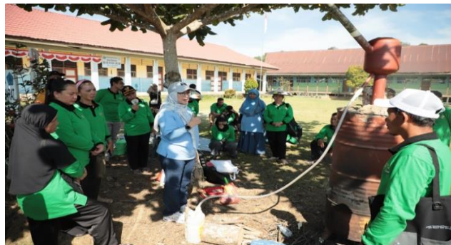
Gambar 1. Proses pirolisis untuk memproduksi biochar dan asap cair
