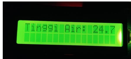
Gambar 13. Hasil Pengujian Menampilkan Ketinggian Air Dalam Tandon
