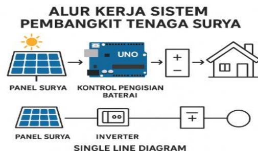
Gambar 4. Alur system pembangkit tenaga surya
